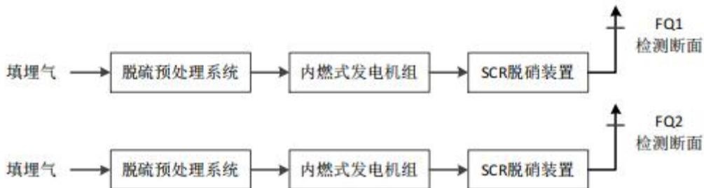
图 2 工艺流程布点图
